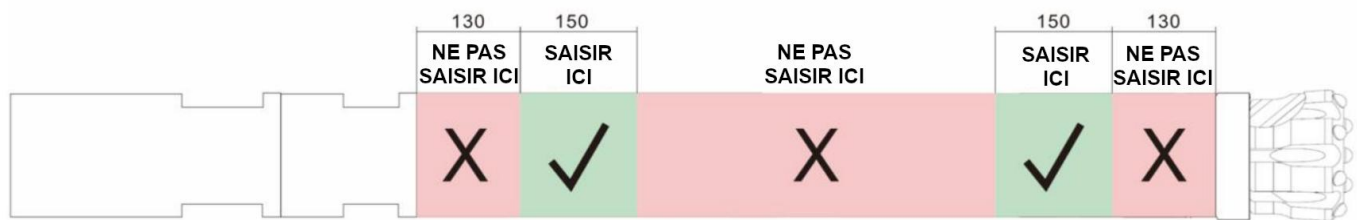
Figure 1 : Emplacements de préhension pour le marteau à circulation inversée BD DRILL
